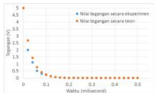
Gambar 11. Kurva perubahan tegangan V_c(t) (kapasitor elektroda plat sejajar berdielektrik udara dengan jarak antar elektroda 3 mm dan resistor 125 megaOhm)
