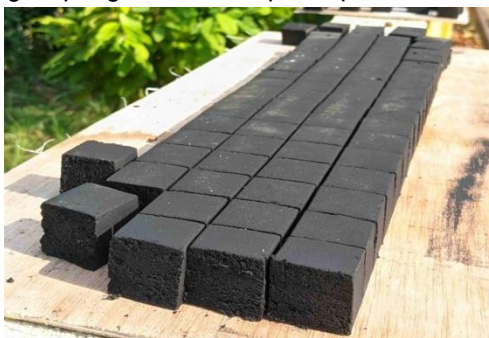
Gambar 6. Proses Pengeringan Briket
