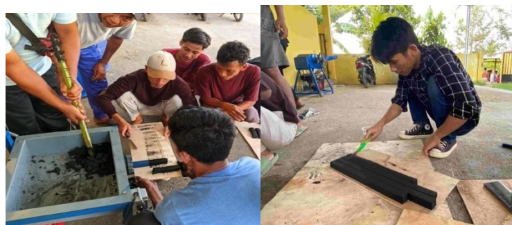
Gambar 5. Proses Pencetakan briket dengan Mesin
