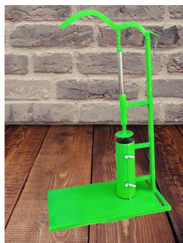
Gambar 7. Hasil Pembuatan Alat Pres Baglog Jamur Tiram
